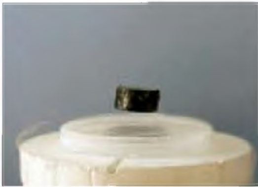
▲ Figura 12.17 Levitación magnética. Un pequeño imán permanente levita por su interacción con un superconductor cerámico que es enfriado hasta la temperatura del nitrógeno líquido, 77 K. El imán flota en el espacio debido a que el superconductor excluye las líneas del campo magnético, una propiedad que se conoce como efecto Meissner.
